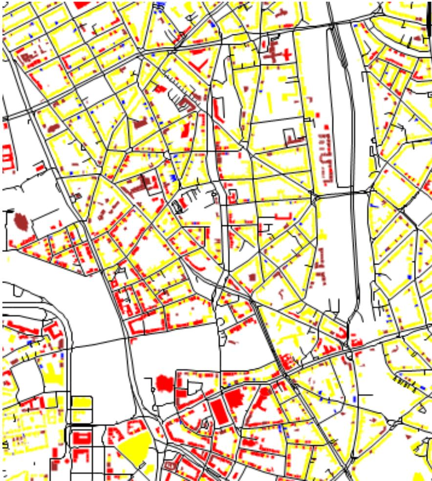
**Abbildung VI-1: Beispiel Trassen und Heizungsstruktur der Gebäude einer Innenstadt (rot = fernwärmeversorgt, gelb = gasversorgt)**
